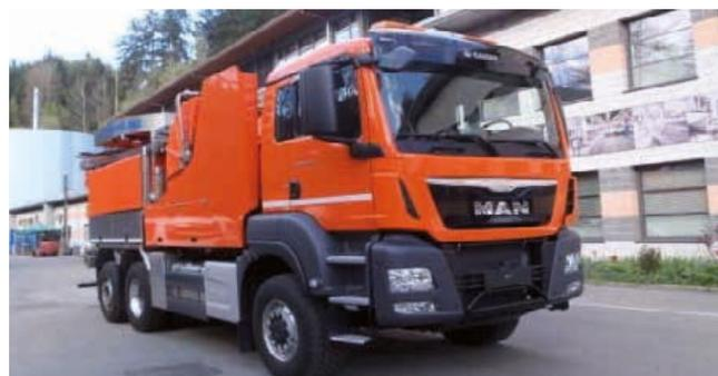
Foto: neues Spülfahrzeug für die Kleinkläranlagen
